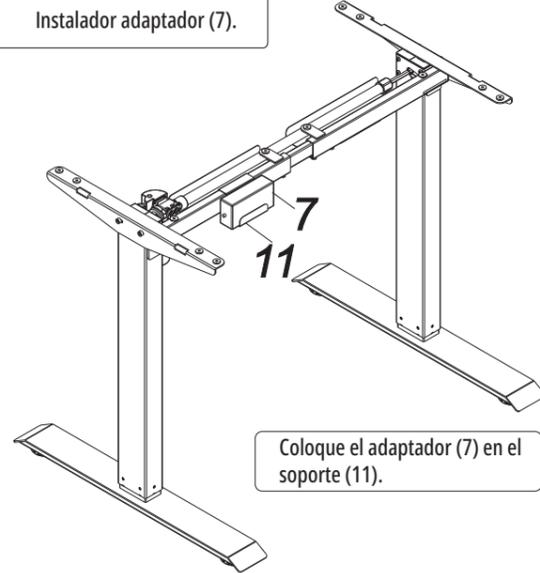
Coloque el adaptador (7) en el soporte (11).
