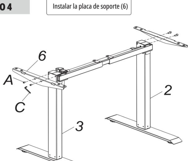
Instalar (6), (2) y (3), usa 5 llave allen (C) para apretar los tornillos.
